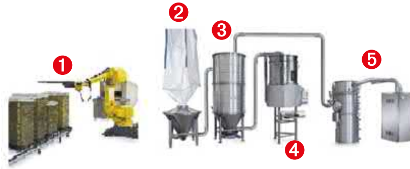
Abb. 4-18 Beispiel eines vollautomatischen Systems: Befüllung der Käfige mit Roboter oder Automaten ①, Befülltrichter saubere Einstreu z. B. mit BIG-Bag ②, optionales Lagersilo ③, Dosierspeicher mit Staubabsaug-einrichtung ④ und Vakuumerzeuger und Staubfilter ⑤ für die pneumatische Förderung.
