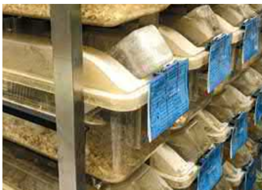
Abb. 9-2 links Käfighaube und Tränkeflasche aus Polysulfon mit milchig weiß aussehender Materialeintrübung, rechts Detailsicht Käfighaube
