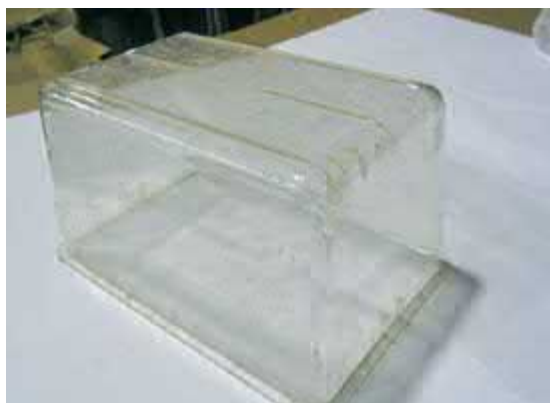
Abb. 9-3 links Ansicht Käfigschale mit Belagbildung, rechts Detailansicht Käfigschale
