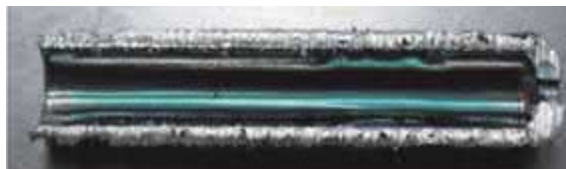
Abb. 9-8 Rechts: Aufgeschnittener Tränkenippel in dem das Wasser korrekt fließen kann
