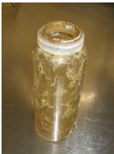
Abb. 7-7 Tränkeflasche mit Prüfanschmutzung
