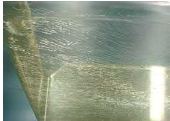
Abb. 9-4 links Ansicht Käfigschale mit Spannungsrissen, rechts Detailansicht Käfigschale
