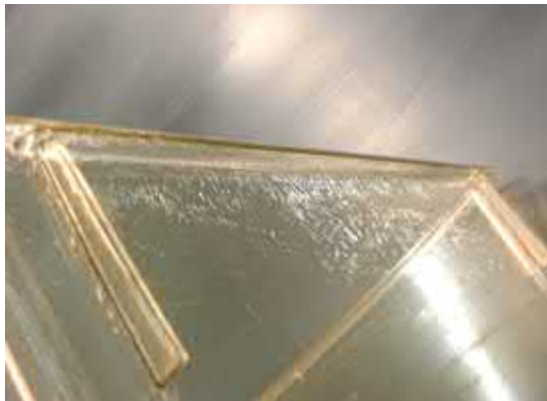
Abb. 9-4 links Ansicht Käfigschale mit Spannungsrissen, rechts Detailansicht Käfigschale
