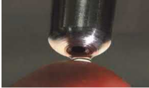
Abb. 9-8 Darstellung Tränkenippel mit Tropfen (Fingertest zum Abziehen eines Tropfens)
