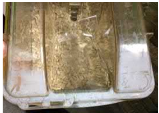
Abb. 9-2 links Käfighaube und Tränkeflasche aus Polysulfon mit milchig weiß aussehender Materialeintrübung, rechts Detailsicht Käfighaube
