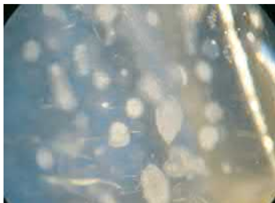
Abb. 9-3 links Ansicht Käfigschale mit Belagbildung, rechts Detailansicht Käfigschale
